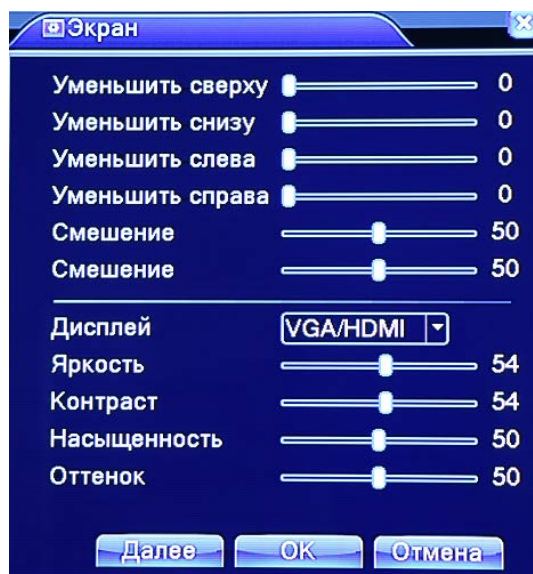
Рис. 3.19 Настройка выходного сигнала
